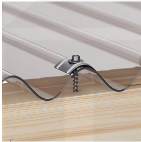
Befestigung auf der Hochsicke mit Schrauben und Kalotten (ca. 10 p/m 2 )
