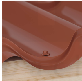
Befestigung in der Tiefsicke mit Schrauben (ca. 8 p/m 2 )
