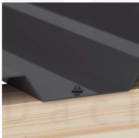
Optionale Befestigung in der Tiefsicke mit Schrauben (ca. 6 p/m 2 )
