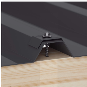
Befestigung auf der Hochsicke mit Kalotten und Schrauben (ca. 6 p/m 2 )
