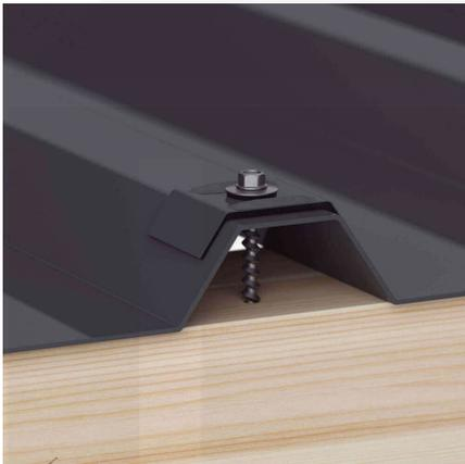
**Empfohlen:** Befestigung auf der Hochsicke mit Kalotten und Schrauben.
