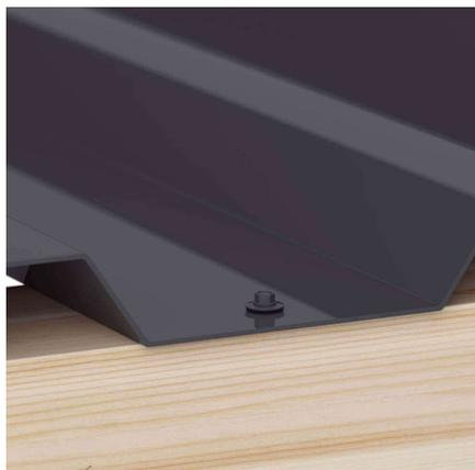
**Optional:** Befestigung in der Tiefsicke mit Schrauben.
