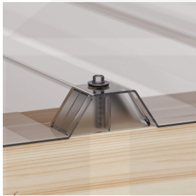
Befestigung auf der Hochsicke mit Schrauben und Abstandhalter (ca. 10 p/m 2 )
