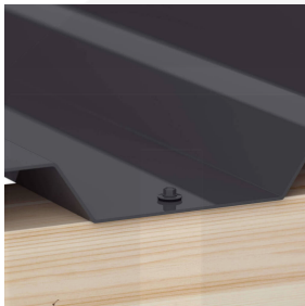
Befestigung in der Tiefsicke mit Schrauben (ca. 6 p/m 2 )
