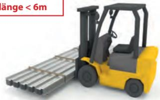
Profiltafeln, die länger als 6 Meter sind, müssen mit einem Kran mit Traverse entladen werden. Um Verformungen und Beschädigungen der Paneele zu vermeiden, müssen zusätzliche Stützen und Seitenschutz installiert werden.
